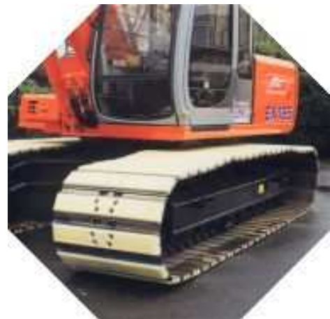
Raupenkettten ausgerüstet mit Felastec® - Polster
