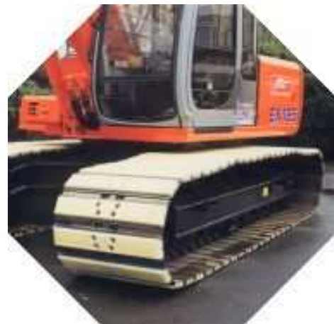
Raupenketten ausgerüstet mit Felastec® - Polster
