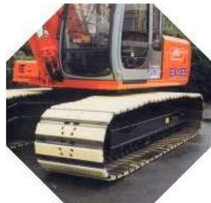
Raupenbagger ausgerüstet mit Felastec® - Polstern
