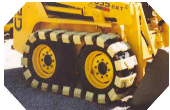
Kompaktlader ausgerüstet mit Felastec® - Raupenband
