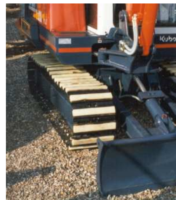
Minibagger ausgerüstet mit elastischen Felastec® - Polstern
